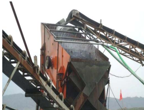
图 6.7.4-2 粗集料水洗装置
